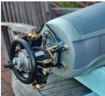
Die Montage des Saito-Sternmotors ist unkompliziert. Hier sitzt der Motor noch auf Distanzstücken, die später entfernt wurden.
