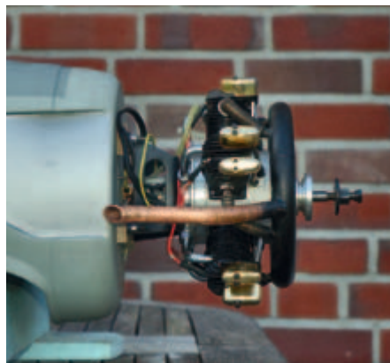
Die Montage des Saito-Sternmotors ist unkompliziert. Hier sitzt der Motor noch auf Distanzstücken, die später entfernt wurden.
