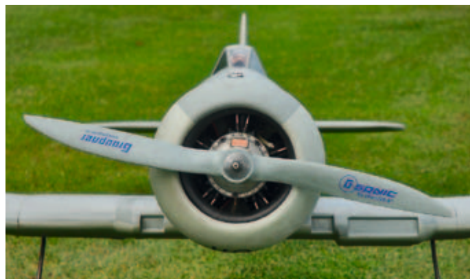
Die Montage des Saito-Sternmotors ist unkompliziert. Hier sitzt der Motor noch auf Distanzstücken, die später entfernt wurden.
