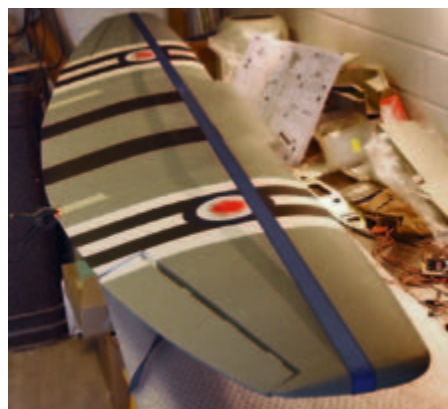
Zum Verkleben wurde die Fläche mit Gurten gespannt.
