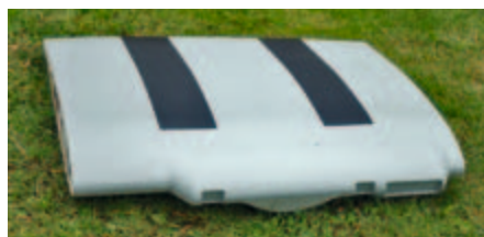
Das Flächenmittelstück ist im vorderen Bereich mit GFK beplankt. Die Spreizklappen reichen über die Verbindungsstelle des Mittelstückes zu den Außenflächen.
