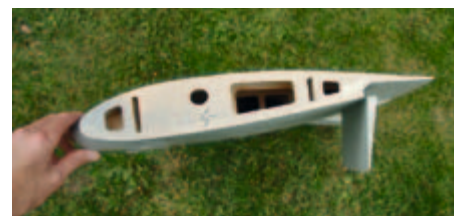
Das Flächenmittelstück ist im vorderen Bereich mit GFK beplankt. Die Spreizklappen reichen über die Verbindungsstelle des Mittelstückes zu den Außenflächen.
