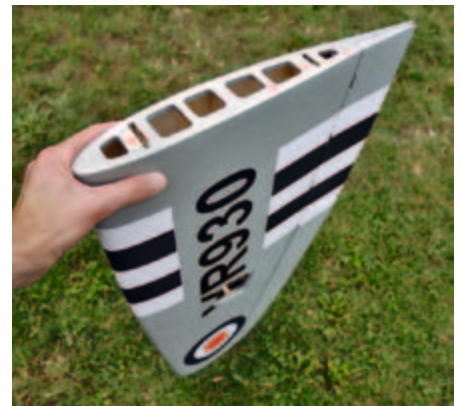
Die Fläche ist dreiteilig – sie wird mit zwei Sperrholzverbindern pro Seite fest verklebt.
